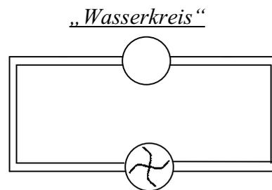
Das Wasser wird von der Pumpe in in eine bestimmte Richtung angetrieben.
