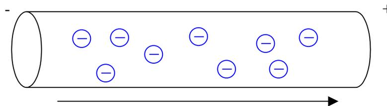
In einer Zeiteinheit fließt eine bestimmte Menge an Elektronen durch den Leiterquerschnitt.
