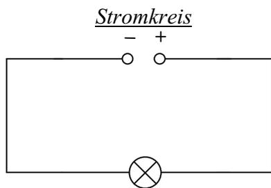
Die Spannungsquelle treibt die Bewegung der Elektronen an.
