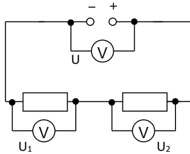
Unsere Messungen ergeben: Im unverzweigten elektrischen Stromkreis ist die Gesamtspannung gleich der Summe der Teilspannungen.
